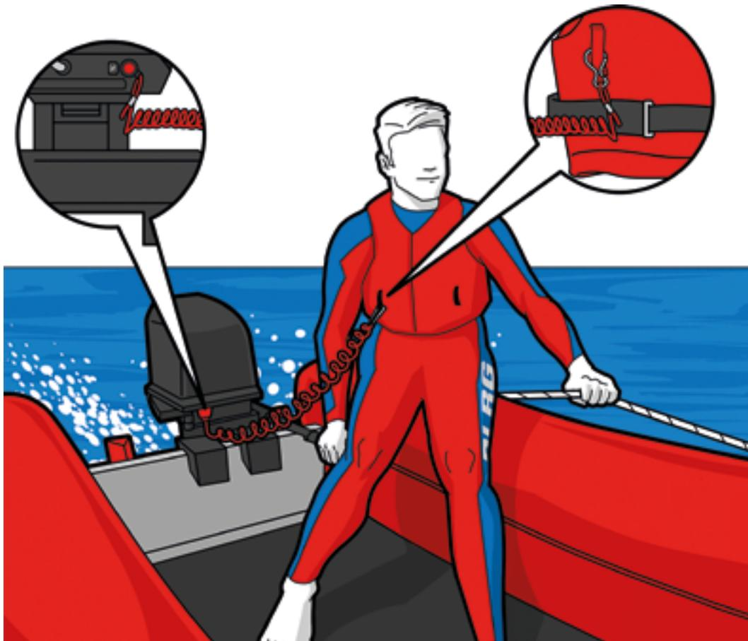
*Abbildung: angelegte Notstoppeinrichtung/Quickstop*
