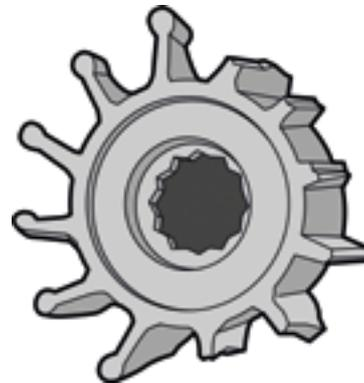
*Abbildung: Zerstörtes Impellerrad*
