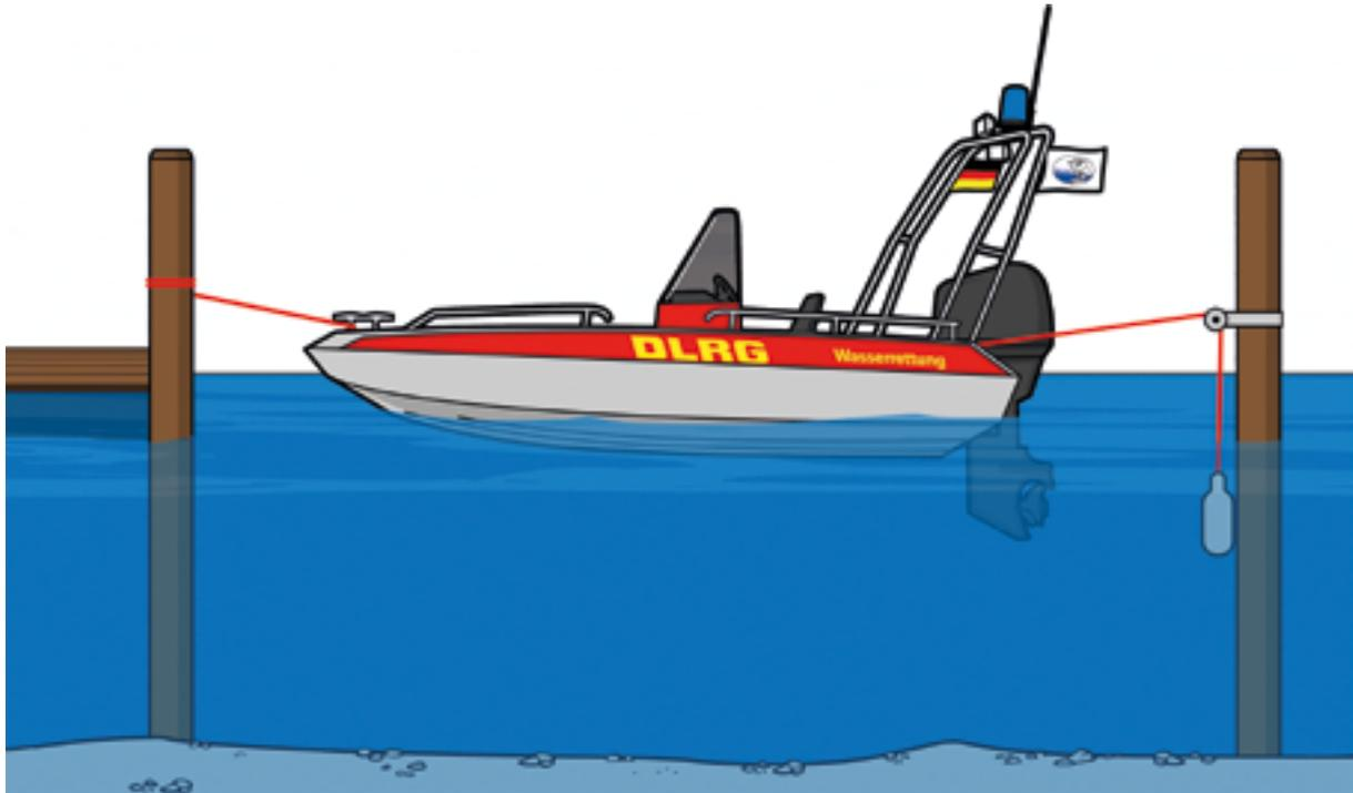
Abbildung: Festmachen mit Umlenkrolle an Heckdalben
